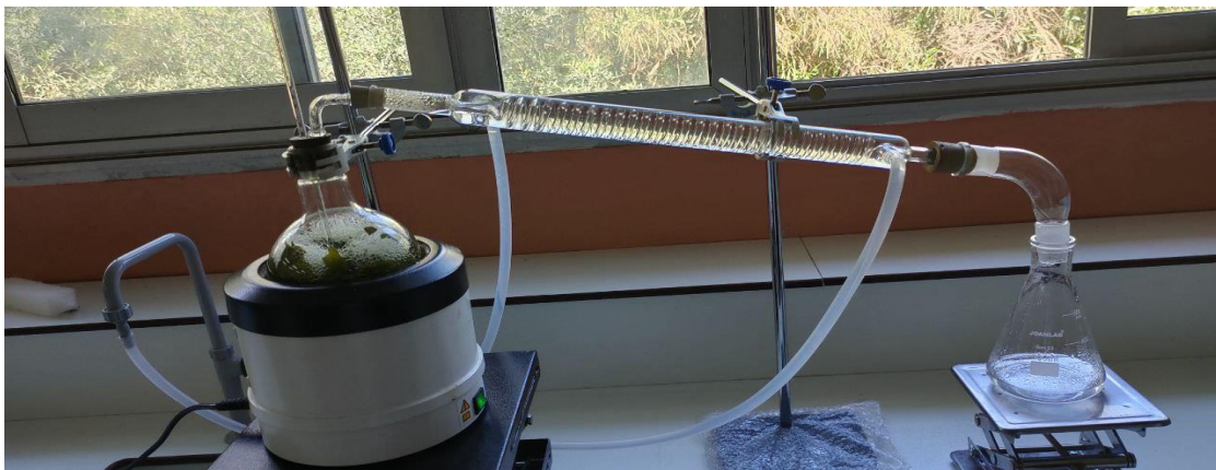
Figure IV.3 : Montage d'hydrodistillation de menthe
