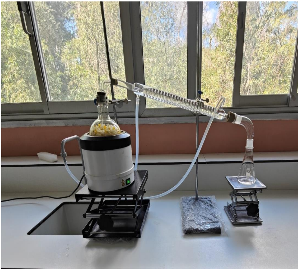
Figure IV.1 : Dispositif de l'extraction des huiles essentielle par l'hydrodistillation
