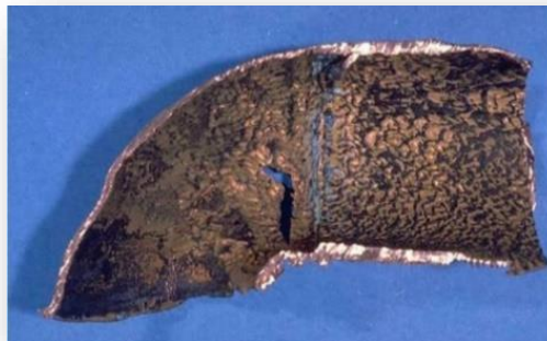
Figure I.14 : la corrosion par érosion
