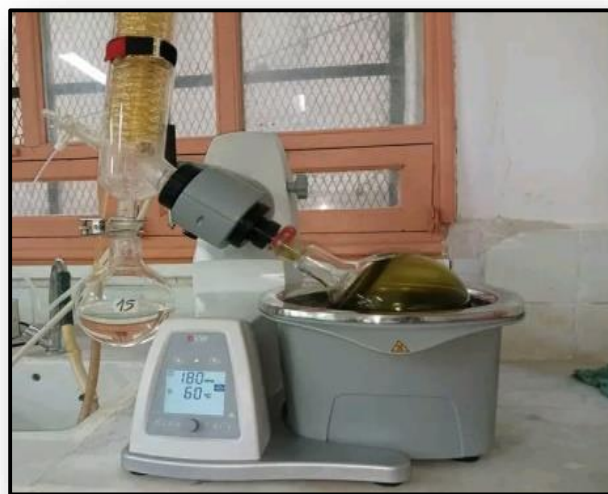
Figure III.7: le montage de l'évaporateur rotatif.
