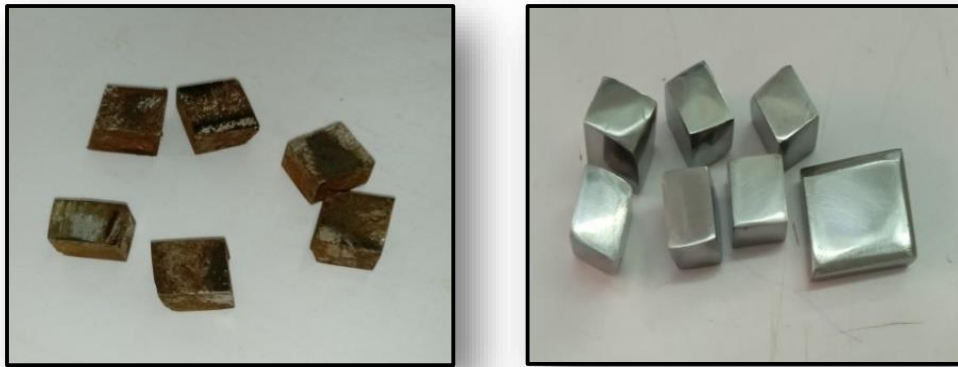
Figure III.13 : Les échantillons avant et après le polissage.
