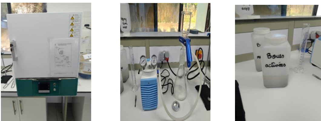
Figure 9 : La technique de filtration
