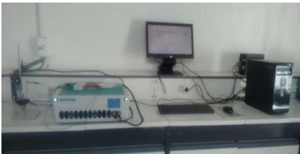
Figure III.5: Potentiostat/Galvanostat, modèle PGSTAT302N contrôlé par un PC à l'aide du logiciel du système électrochimique général (GPES) fourni par AUTOLAB
