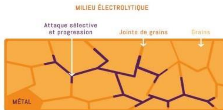
Figure I.7 : Principe de la corrosion intergranulaire (généralités) [16].
