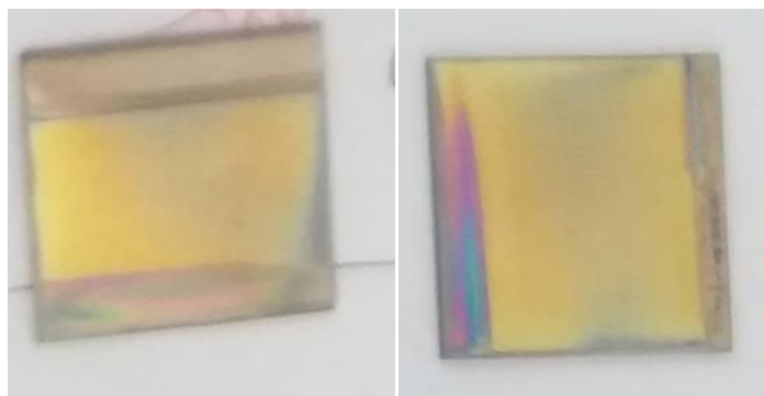
Figure III.2 : Échantillons d'acier inoxydable 304 revêtus de films minces multicouches TiO 2 /ZnO
