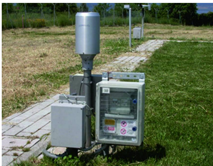
Figure I.3. Exemple d'un pluviomètre (Cauteruccio et al., 2021).
