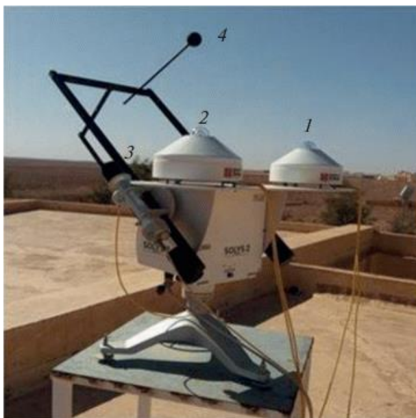
Figure I.2. Les instruments de mesure de la RS globale, directe et diffuse : (1) Pyranomètre pour mesurer la RS diffuse, (2) Pyranomètre pour mesurer la RS globale, (3) Périhéliomètre pour mesurer la RS directe, et (4) La boule utilisée pour cacher définitivement le pyranomètre (Rabehi et al., 2021)
