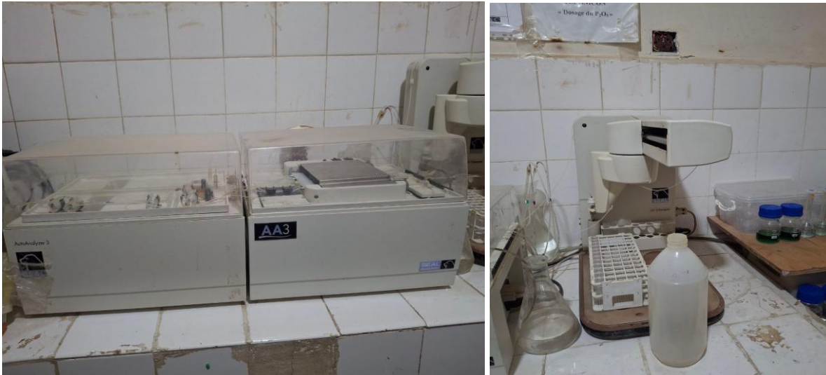
Fig18. Auto-analyseur technique du dosage de P_2O_5 .
