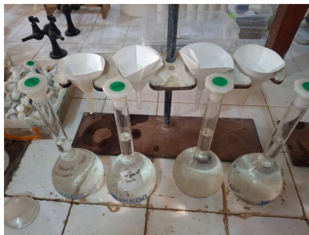
Fig17. Des fioles jaugées de 500 mL remplies de la solution diluée de PN ou PB avec l'acide Perchloric.
