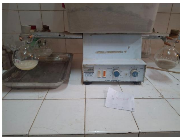
Fig19. L'opération de l'agitation de PN et PB avec l'acide citrique et l'eau.
