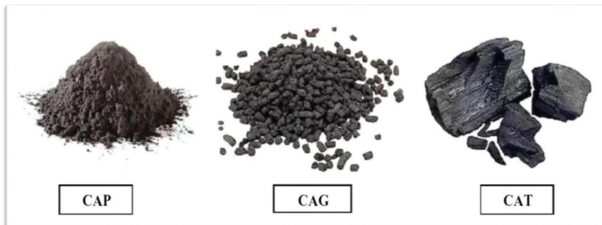
Figure III.3 : Différentes formes de charbon actif
