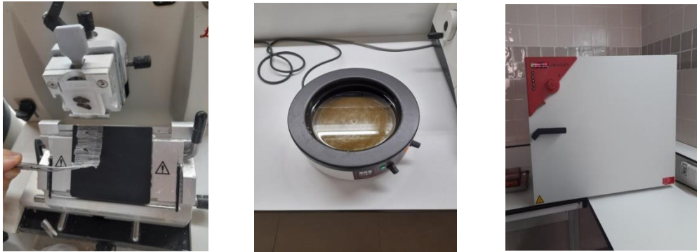
Figure 32: Photographie récapitulant les étapes de la coupe (bain marie (A) microtome (B) l'étuve (C)) (photo originale, 2023).
