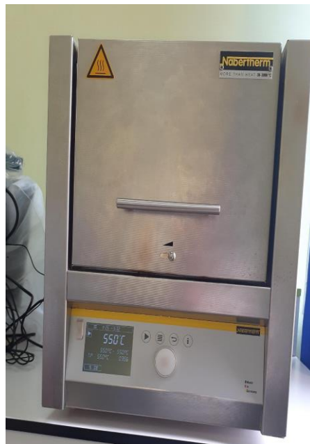
Figure IV.7 : Four à moufles pour la détermination de la matière organique
