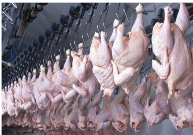
Figure N° 06 : Ressuyage par air ventilé (Anonyme 7, 2023).
