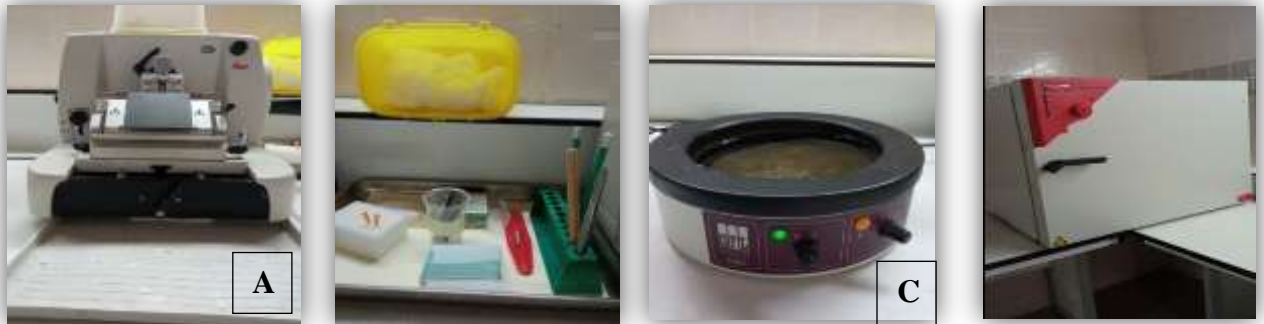
Figure 27 : matériels de la coupe A_microtome, B_lames, C_bain marie, D_l'étuve 140°C. (Photos originale).
