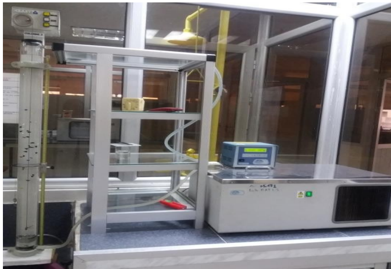
Figure II.4 : Dispositif pour la mesure de la densité à 23°C
