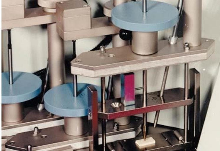
Figures II.3: Appareil du point de ramollissement Vicat
