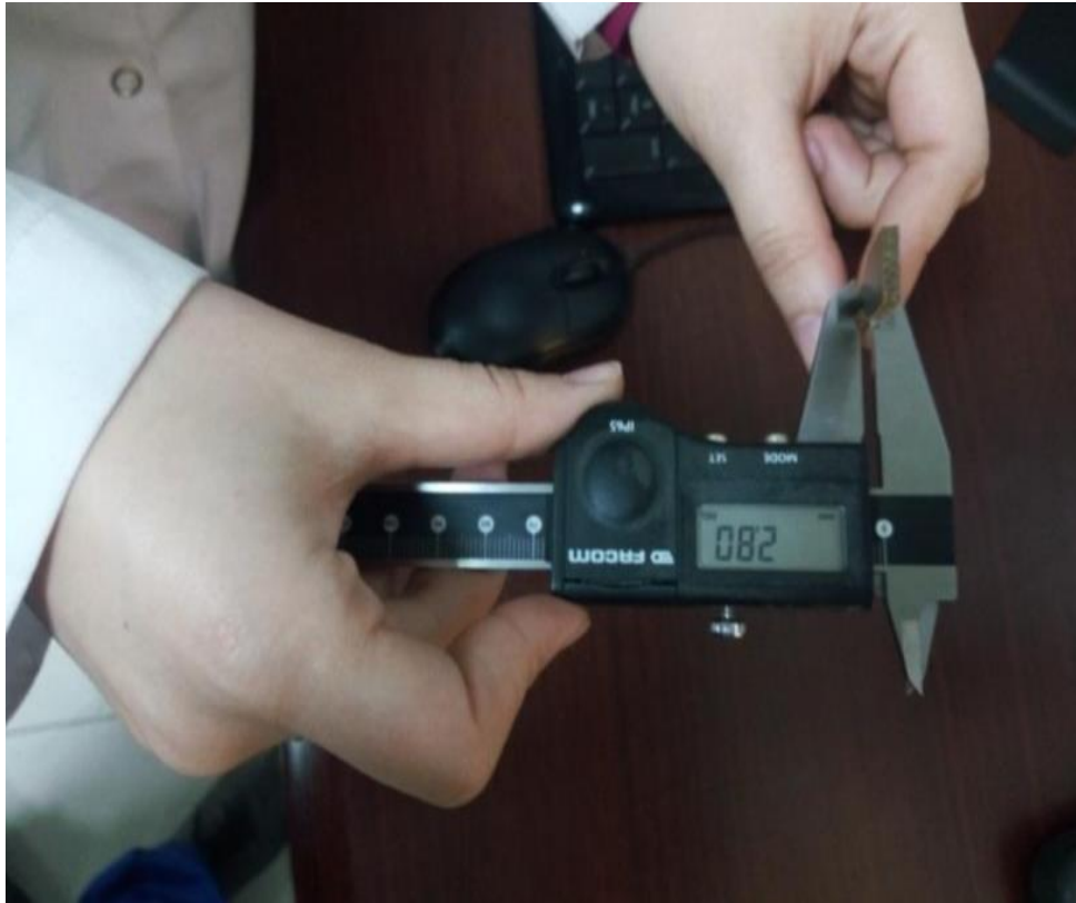
Figure IV.11: Mesure des dimensions de l'éprouvette.
