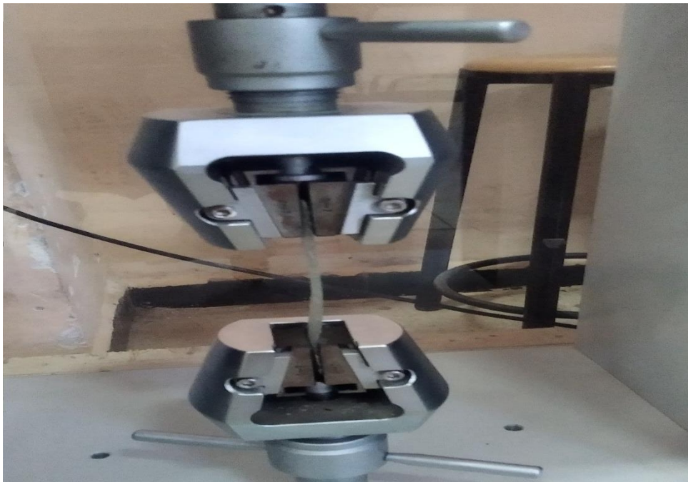
Figure IV.12: Éprouvette d'essai mise en place dans la machine de traction.
