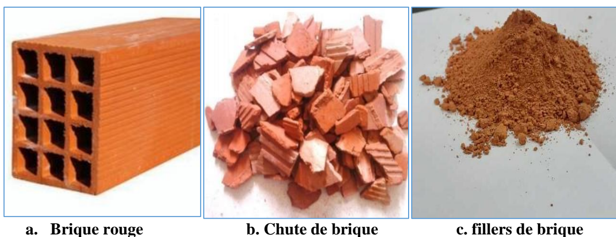
Figure II-4: Echantillon des fillers de brique recyclé
