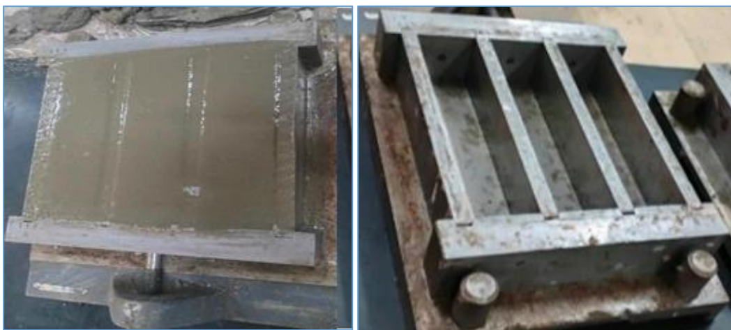
Figure III-2: Moule triple pour prismes 4x4x16cm 3
