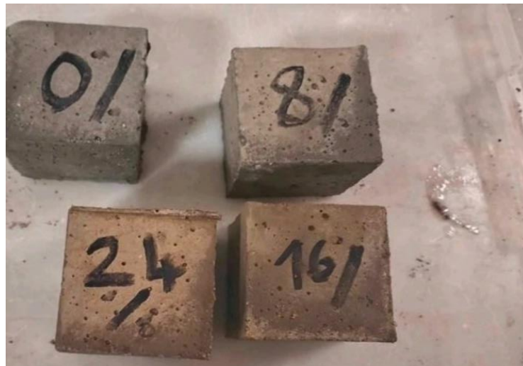
Figure III-22: Epreuves immergées dans la solution 4% NaCl
