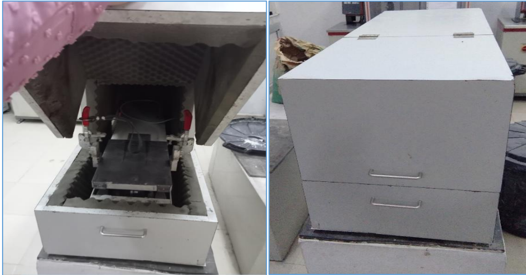
Figure III-3: Table à chocs et remplissage des éprouvettes
