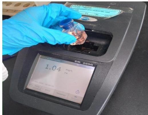
Figure 10: Détermination de Fer par spectrophotomètre (photographie personnelle)
