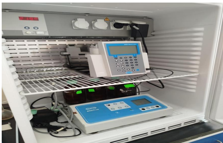
Figure 12: Détermination de DBO 5 par l'incubateur (photographie personnelle)
