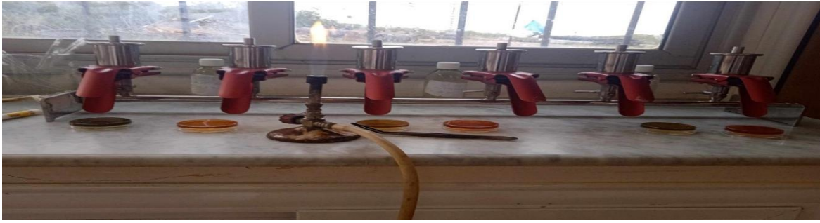
Figure 3 : Rampe de filtration (photo originale de laboratoire de l'ADE)
