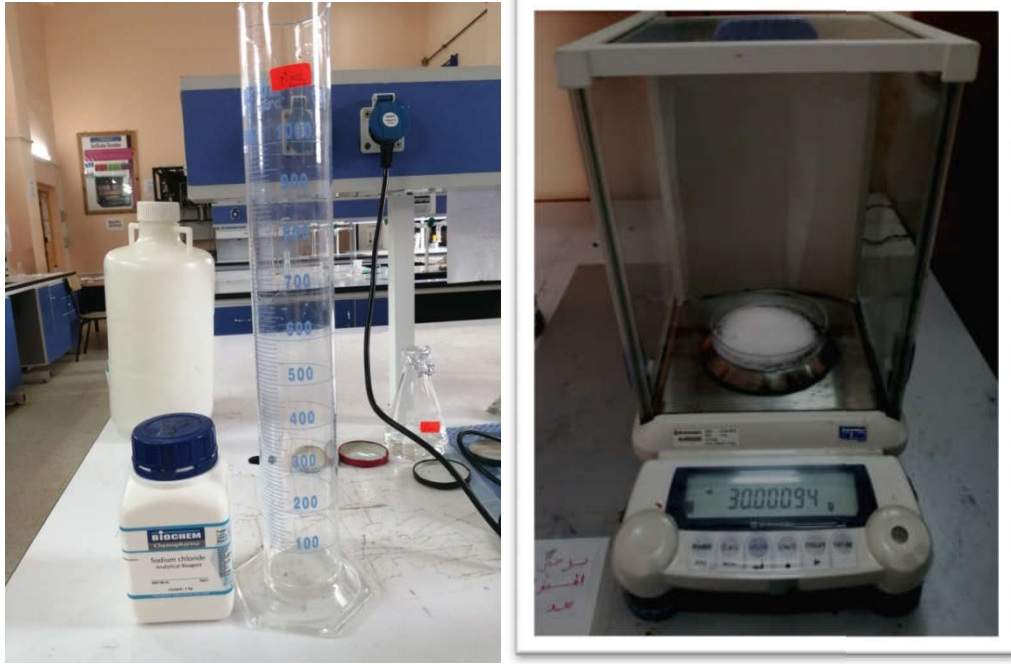
Figure II-7 : Préparation de la solution corrosive (NaCl 3%)
