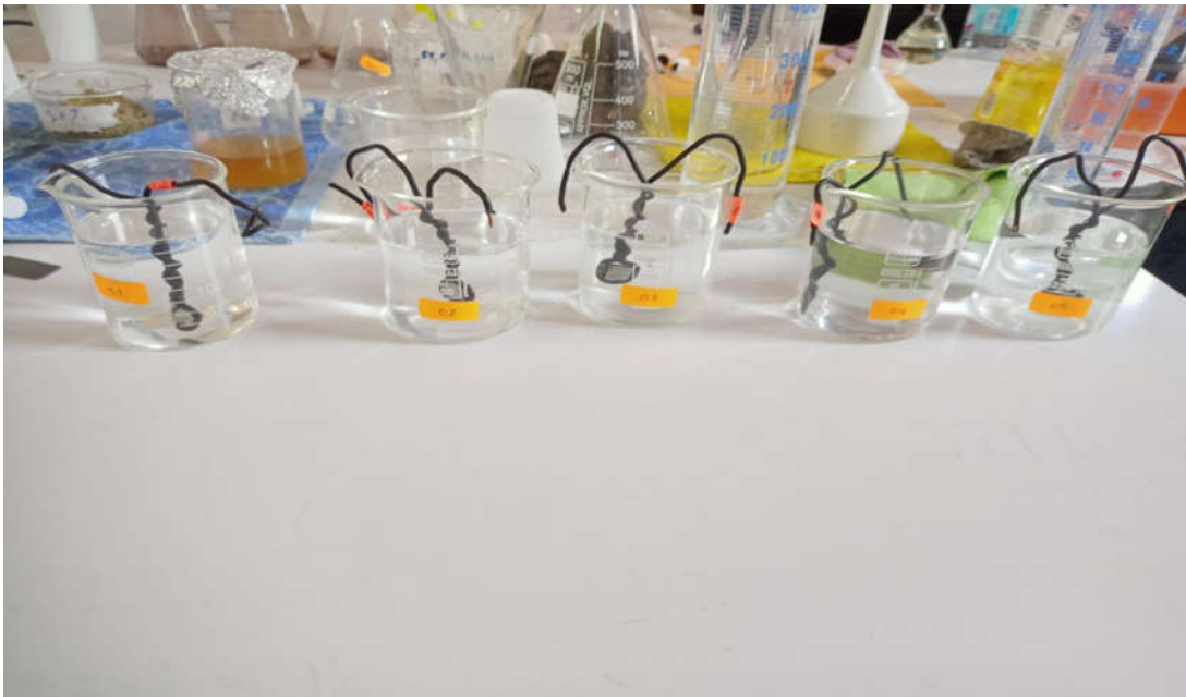
Figure II-9: Echantillons d'acier A106/A placés dans des béchers contenant une solution de NaCl à 3%.
