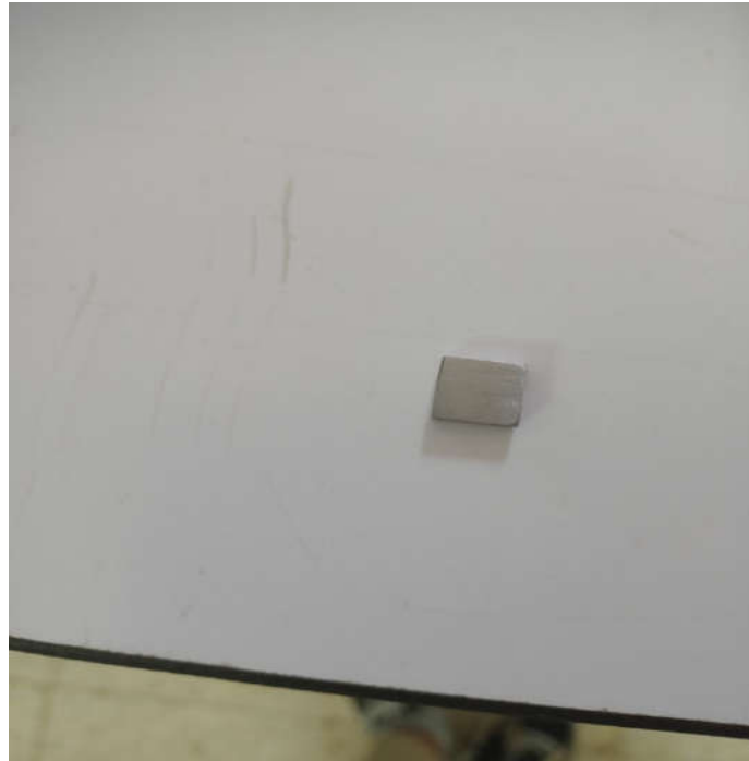
Figure II-8 : Echantillon de l'acier A106/A.
