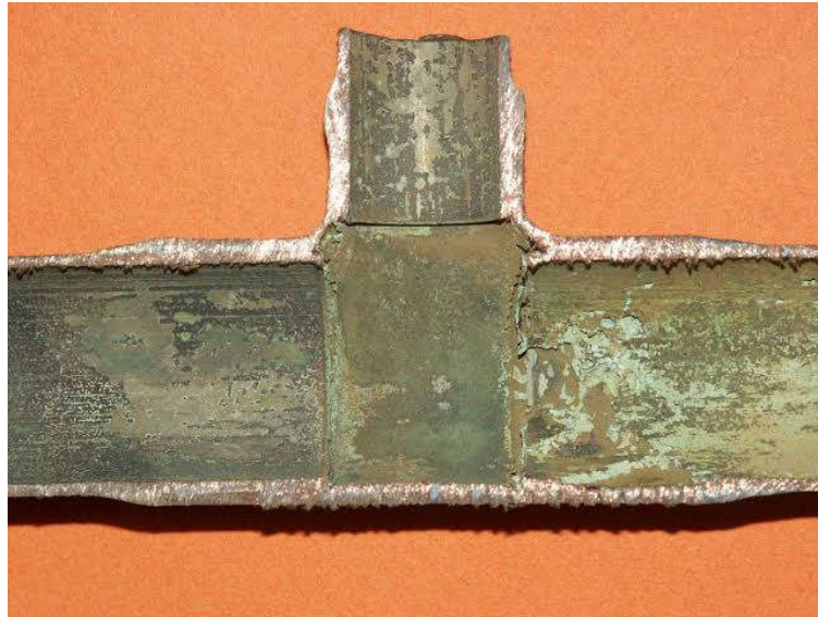
Figure I.8 : Corrosion sous contrainte.
