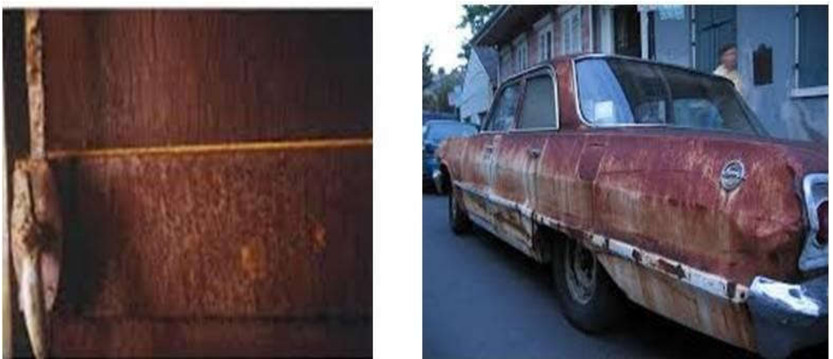
Figure I.1: Corrosion généralisée exemple d'une porte d'un véhicule corrodés.
