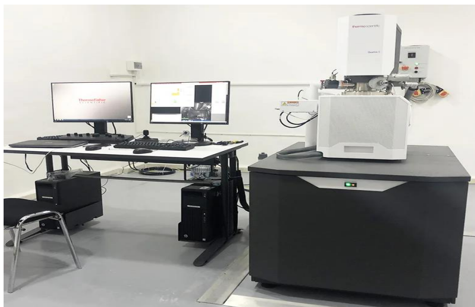
Figure III.3. Appareil du microscope électronique à balayage.
