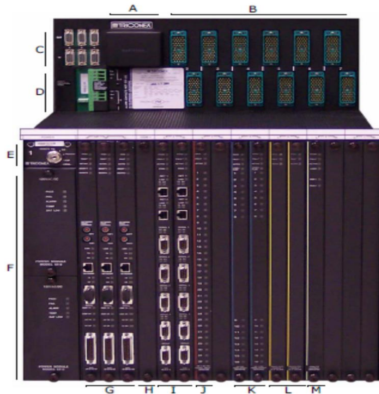
Figure II.6: Les éléments compositeurs d'un automate TRICON
