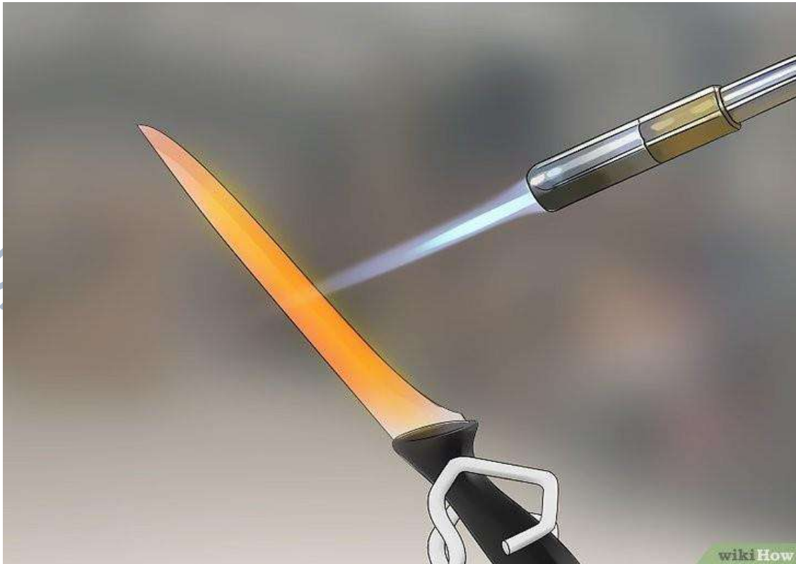
Figure V 2 Changement de couleur de l'acier pendant le chauffage
