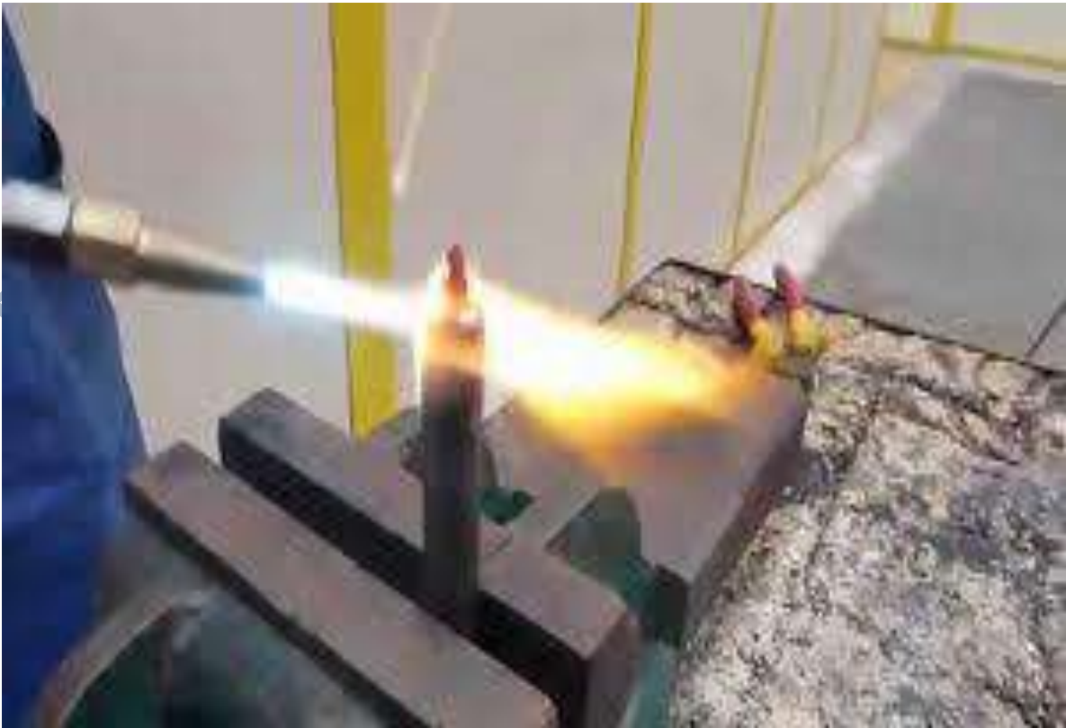
Figure IV 2 Systèmes de chauffage par CHALUMOU
