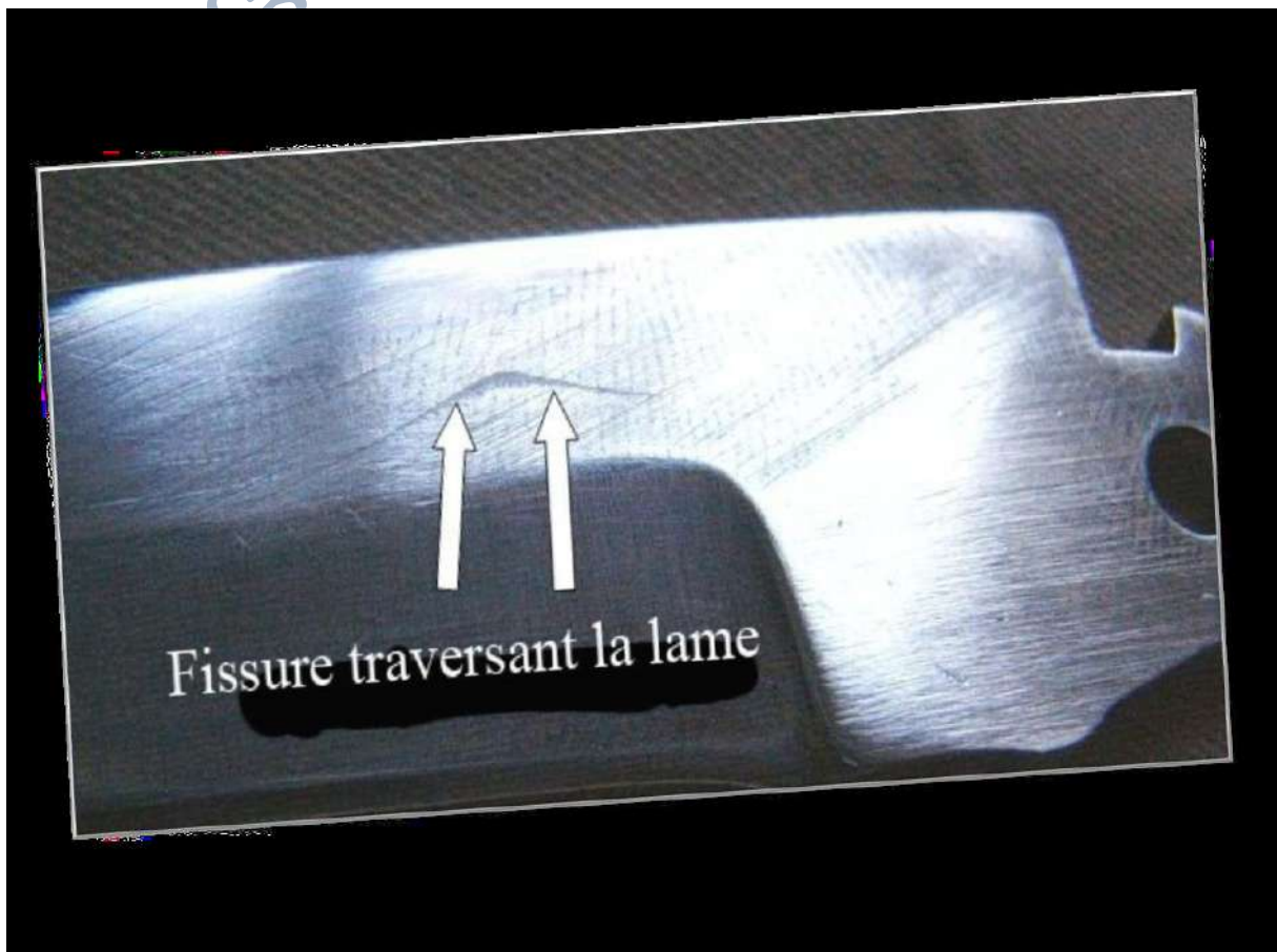
Figure III 5 Exemple de lame en acier ayant subi une trempe mais sans revenu, elle représente des fissures
