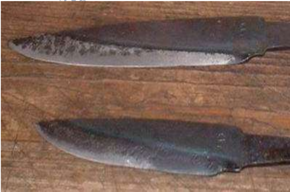
Figure III 4 Trempe sélective de couteaux
