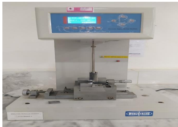
Figure IV.14 : Photo représentatif de l'appareillage de choc [8].
