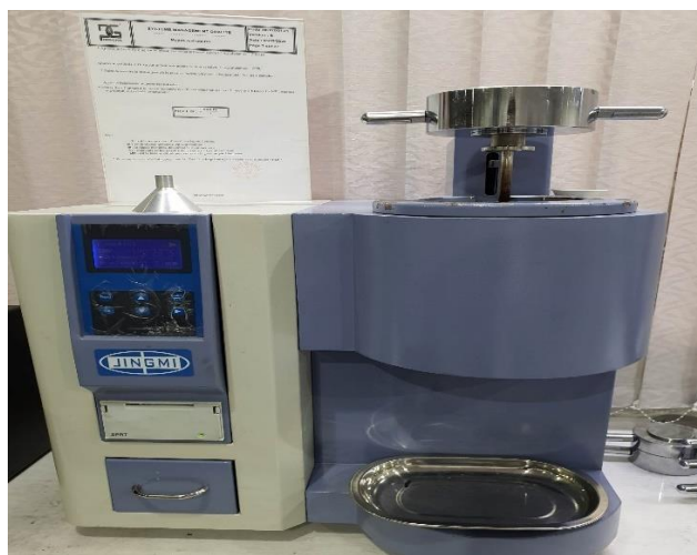
Figure IV.8: Appareillage de mesure du Melt Flow Index .
