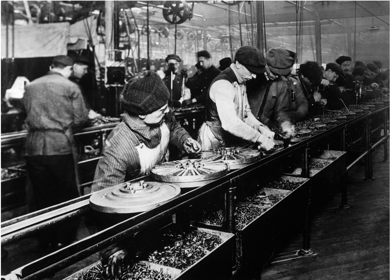
FIG. 1: Ouvriers sur la première chaîne de montage des automobiles Ford de 1913 1 .
