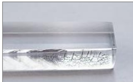
Figure I.10 : Corrosion sous contrainte
