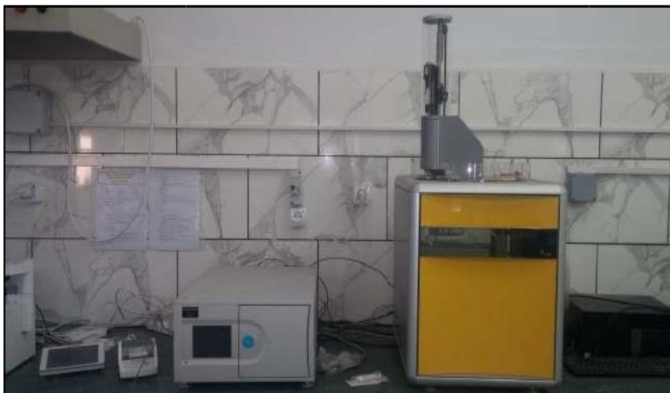
Figure V.4 Appareil de mesure de la teneur en soufre total dans le pétrole brut.
