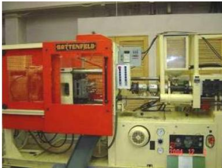
Figure I.15 Machine de moulage par injection (Battenfeld Maschinen, Allemagne) au Northern Alberta Institute Technology (NAIT).
