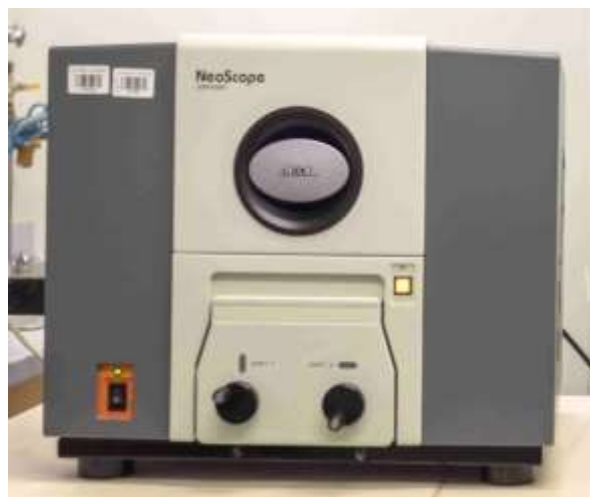
Figure II.8 : MEB modèle JCM-5000 NeoScope utilisé pour caractériser nos films d'argent.
