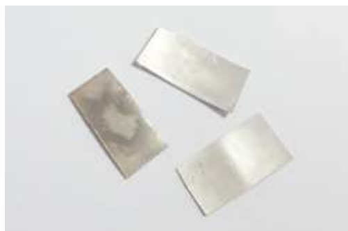
Figure II.6 : Séchage à l'air libre des substrats en PET après dépôt chimique de l'argent.
