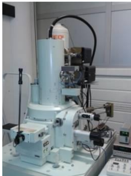
Figure II.8. Microscope électronique à balayage utilisé dans la caractérisation des couches minces \text{SnO}_2 .
