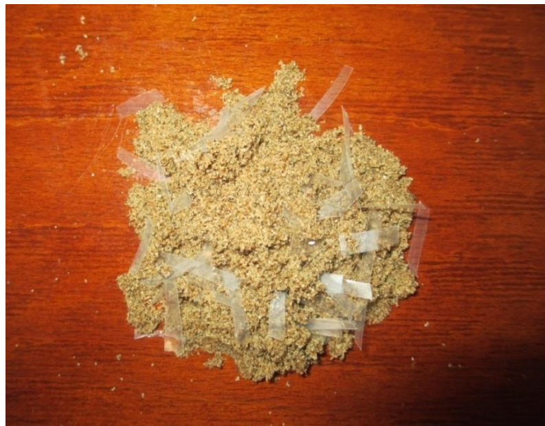
Figure III.9 Aspect du sable renforcé par fibres plastiques
