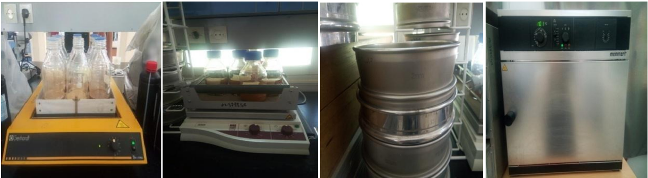
Figure n°13 : Les matériels utilisés dans la granulométrie (Bin de sable, Agitateur, des tamis et étuve)
