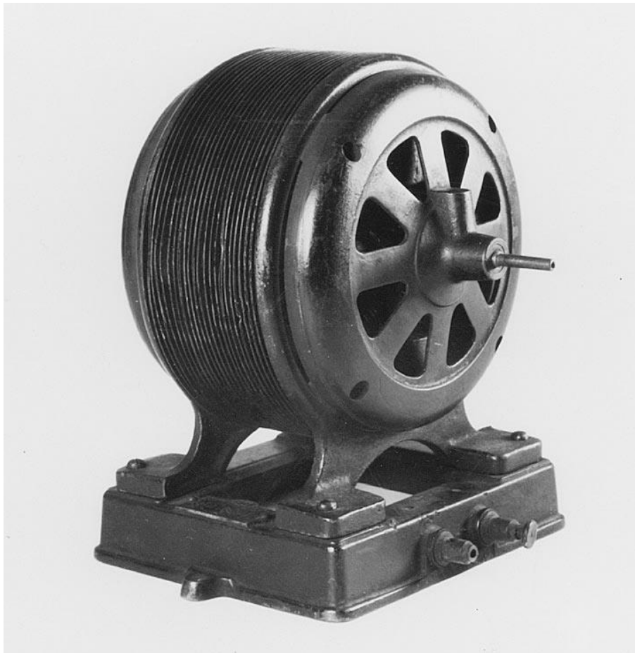
Fig.1.11 - moteur à induction biphasé de Tesla, 1888 [8].
