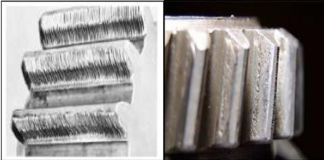
Fig II.20 : L'usure sur les dents des engrenages[11].
