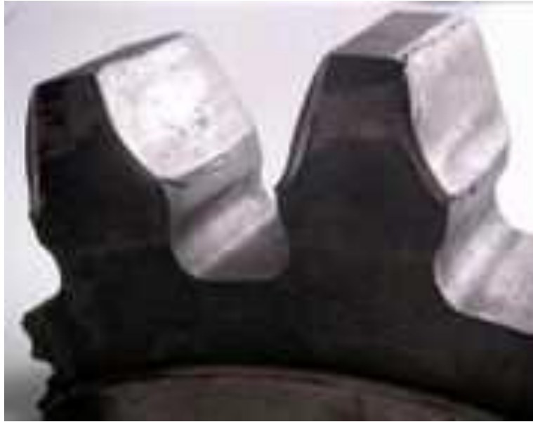
Fig II.21 : Déformation plastique par roulage des dentures [11].
