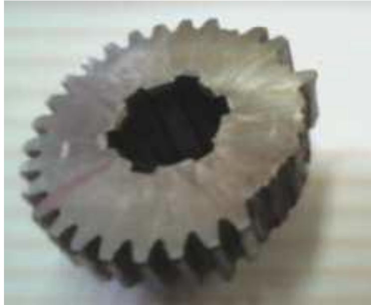
Fig II.14 : Rupture par fatigue [11].
