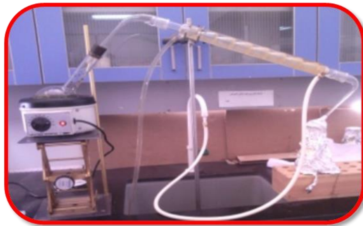
Figure 17 : Montage d'hydrodistillation employé pour l'extraction des huiles essentielles.
