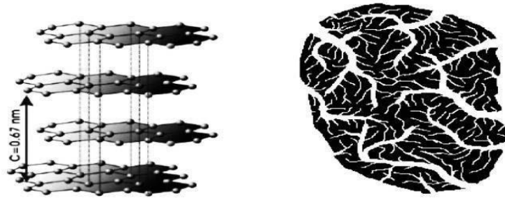
Figure I.2 : Structure chimique du charbon actif et représentation schématique de sa structure
