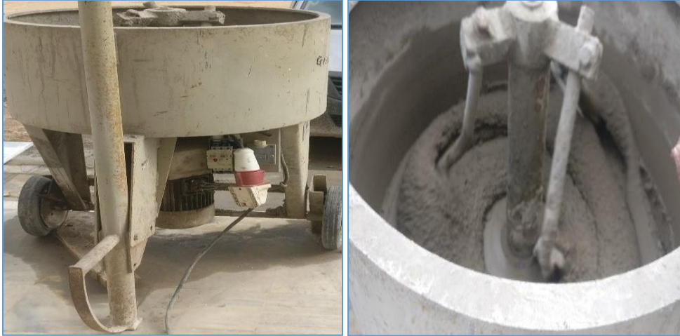
Figure III.1: Malaxage du béton de sable
