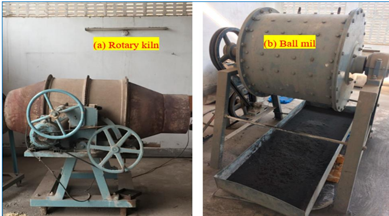
Figure I.4: (a) Four rotatif pour la calcination des pailles de blé à différentes températures variant de 550 à 750 °C ; (b) Broyeur à boulets pour le broyage des cendres de pailles de blé brûlées (Amin et al., 2019)
