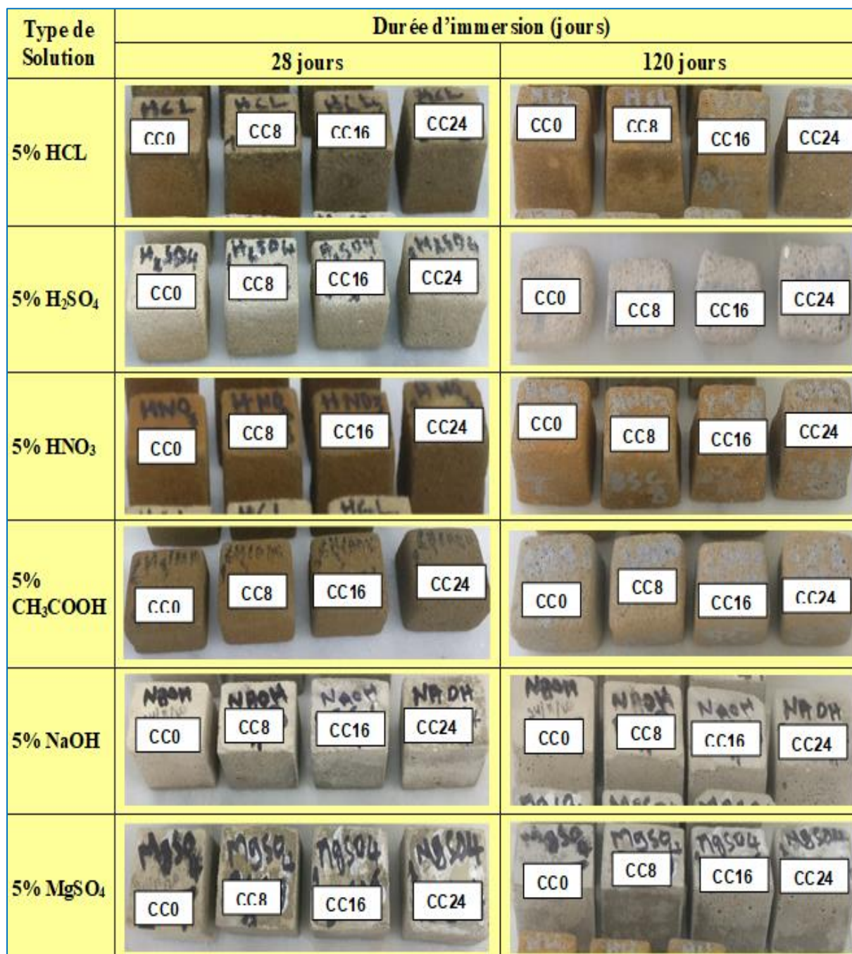
Figure V.27: Aspects des spécimens des bétons de sable à base de cendres de canne après 28 et 120 jours d'exposition aux solutions d'attaque chimiques
