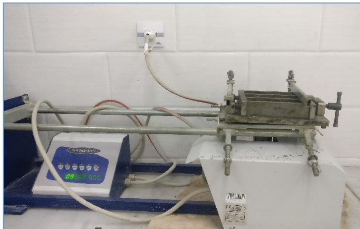
Figure III.3: Vibration de béton de sable sur la table à chocs
