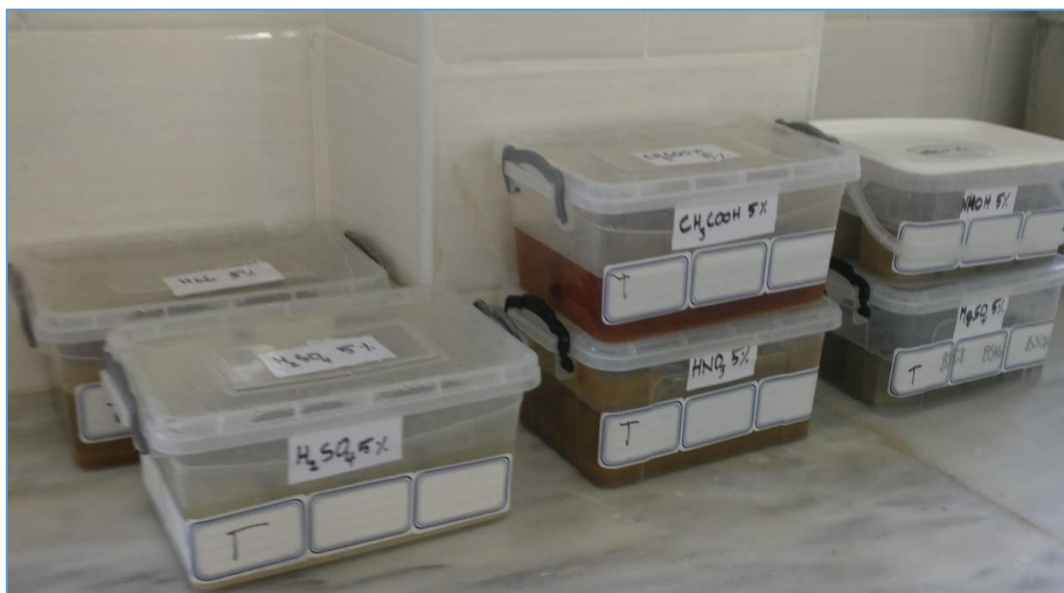
Figure III.21: Conservation des éprouvettes (50x50x50) mm 3 dans les solutions d'attaque chimiques
