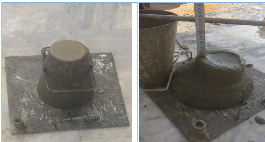
Figure III.10: Essai d'affaissement au cône d'Abrams.
