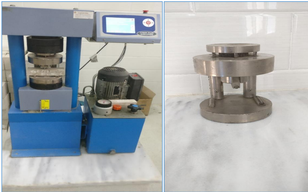
Figure III.15: Essai de traction par flexion trois points
