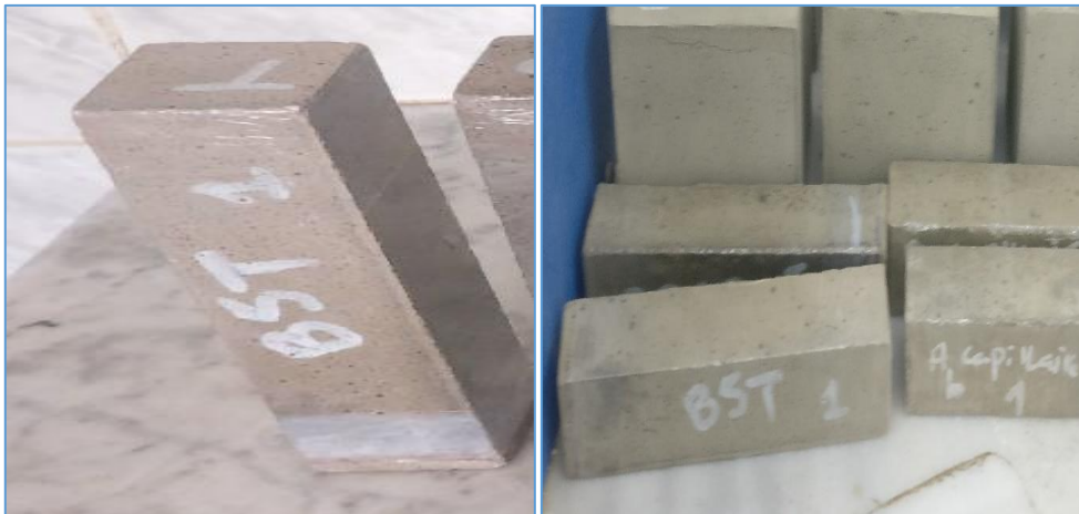
Figure III.19: Eprouvettes avec faces latérales enveloppées pour l'essai de l'absorption capillaire
