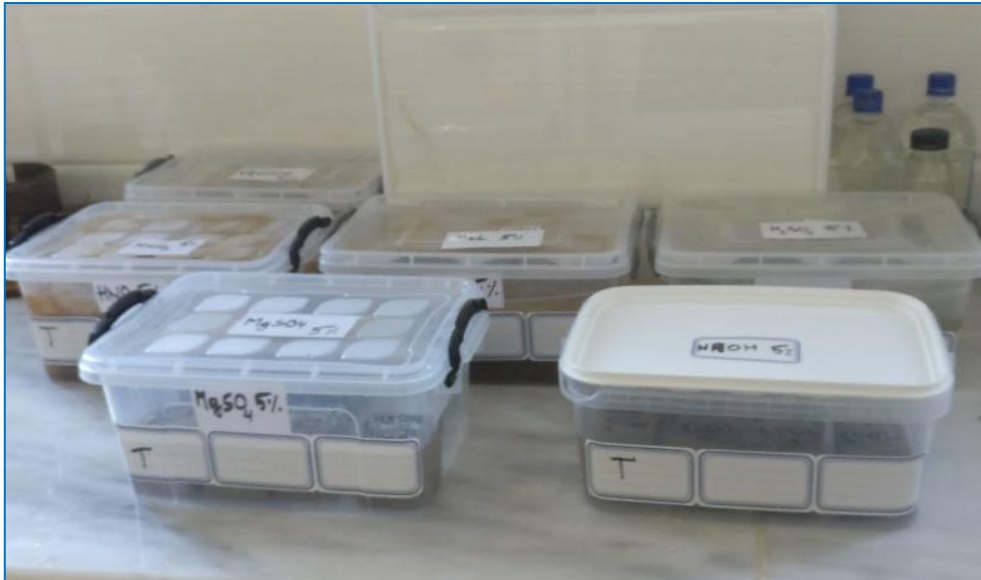
Figure III.9: Conservation des éprouvettes 5x5x5 cm 3 dans les solutions d'attaque chimiques
