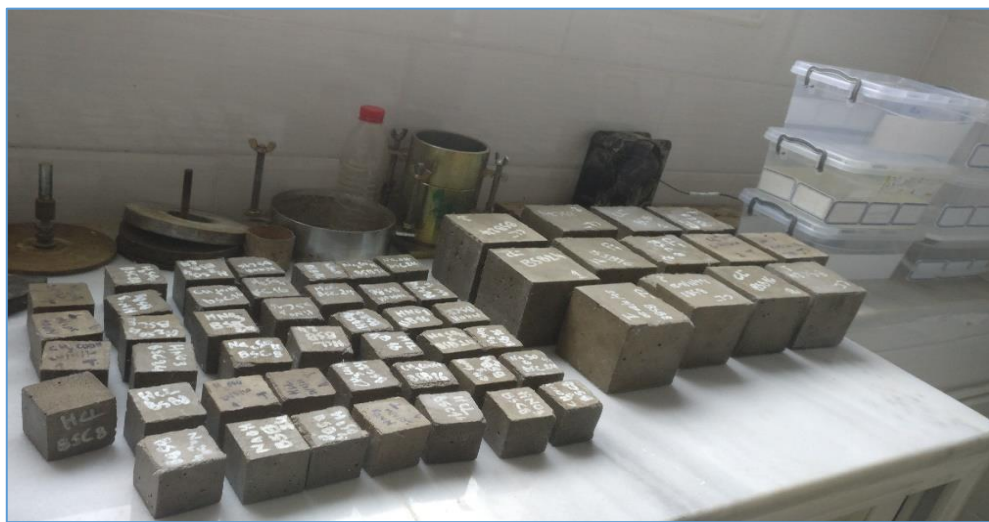
Figure III.7: Eprouvettes avant conservation dans les solutions d'attaque
