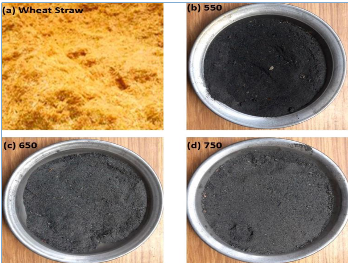
Figure I.18: (a) Paille de blé avant combustion; (b) Cendres de paille de blé (WSA) à 550 °C; (c) WSA à 650 °C ; (d) WSA à 750 °C (Amin et al., 2019)
