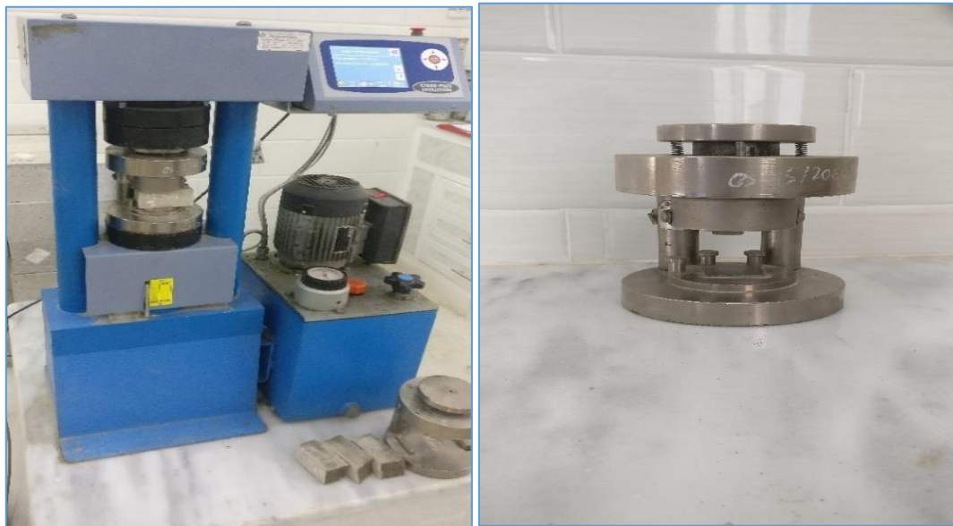
Figure III.14: Essai de compression sur éprouvette 4x4x16 cm 3
