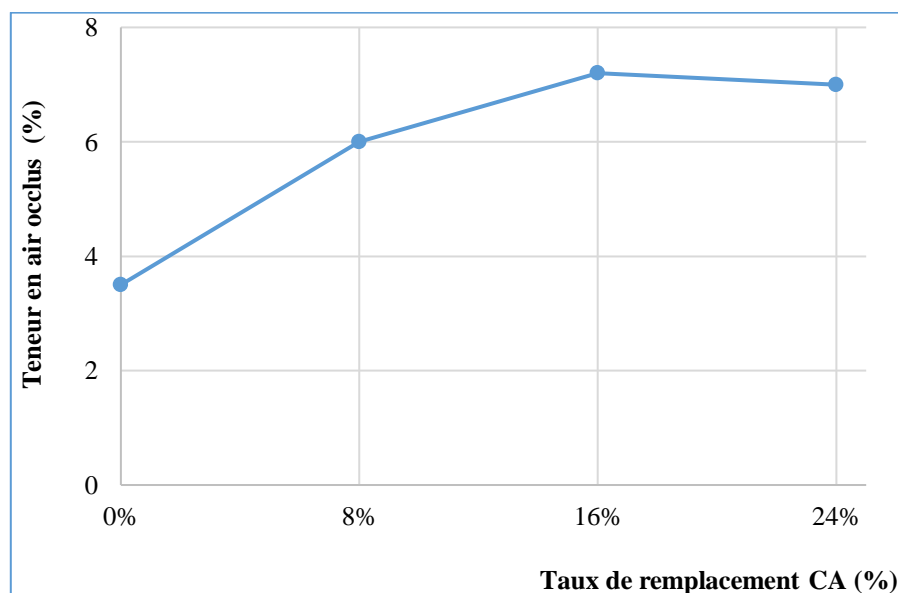
Figure IV.2: Effet % CA sur la teneur en air occlus du béton de sable
