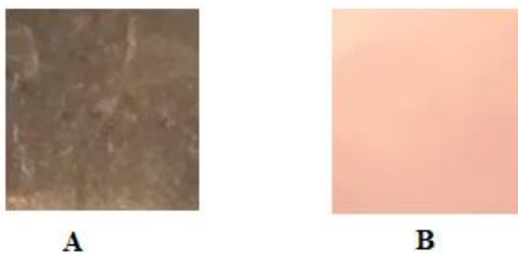
Figure II.5 : Plaque de cuivre avant polissage (A) et après le découpage polissage (B)
