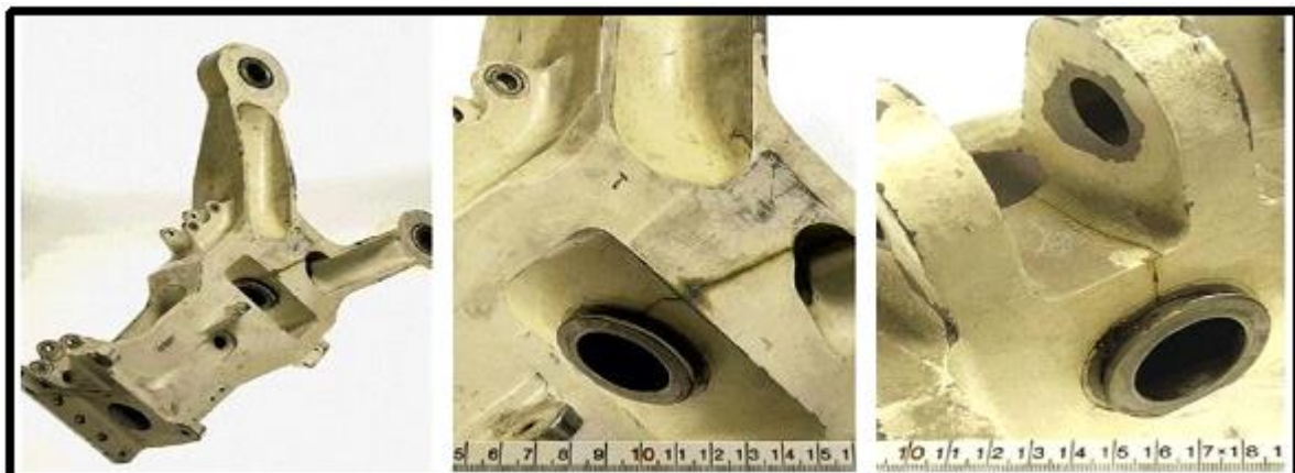
Figure I.9 : Fissuration par corrosion sous contrainte d'un support latéral d'un avion.
