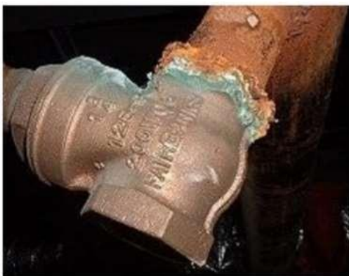
Figure 19 : Corrosion galvanique résultante d'un assemblage de deux métaux différents : robinet en cuivre et conduite en acier galvanisé.
