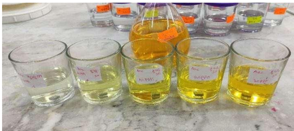
Figure 55 : mesure de perte de masse dans le milieu corrosif en présence d'inhibiteur à différentes concentrations.
