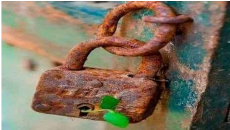
Figure 16 : Exemple de corrosion généralisée.
