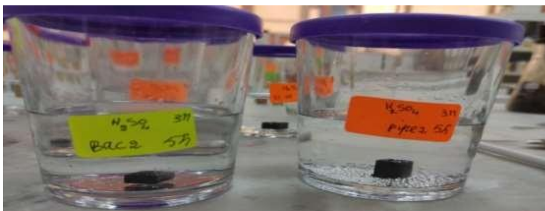
Figure 54 : mesure de perte de masse dans le milieu corrosif en absence d'inhibiteur.
