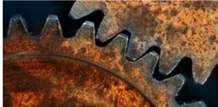
Figure 29 : Corrosion par frottement
