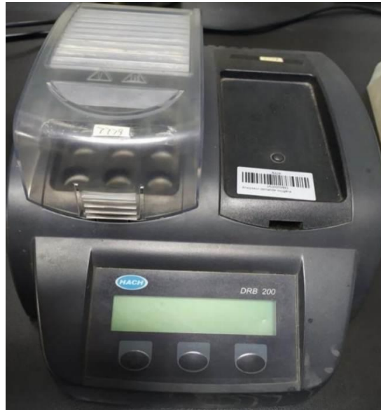
Figure IV.5 : Réacteur HACH DRB200.
