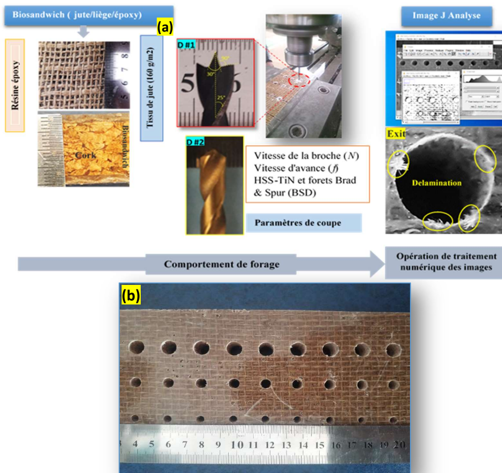
Figure IV-1 Disposition schématique du perçage de la structure du biosandwich.
