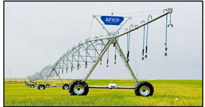
Figure VI.3 : Tubes suspendus avec mini-diffuseurs
