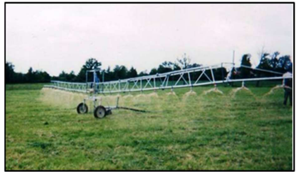
Fig V.1 : Rampe d'aspersion en service sur son chariot.
