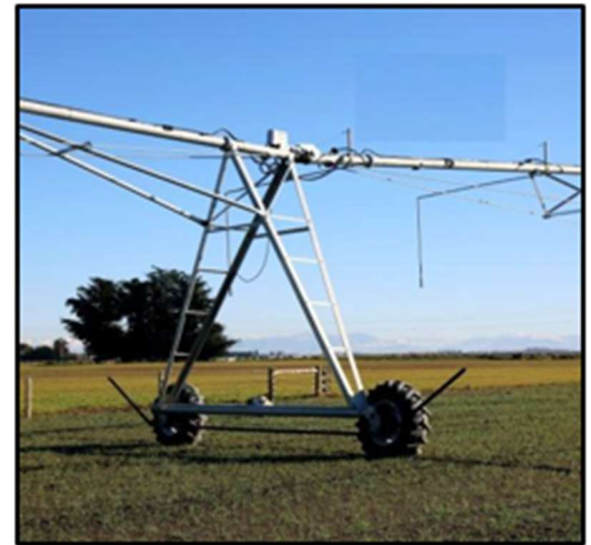
Figure VI.5 : Les tours de support
