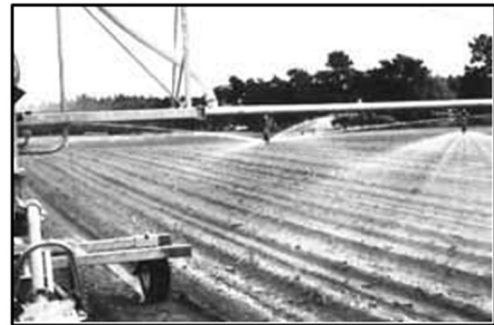
Fig V.3 : Mini-diffuseurs en cercles complets et demi-cercles
