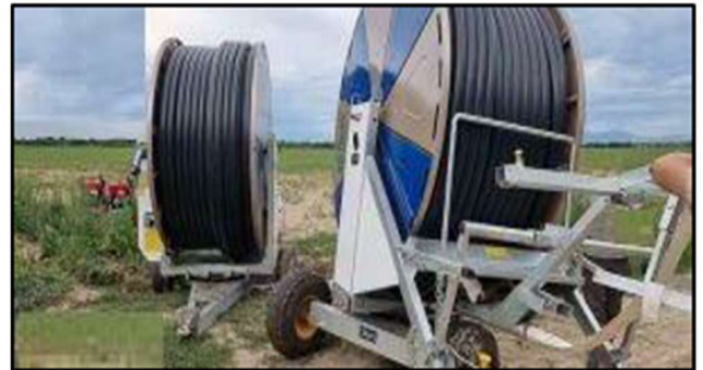
Figure V.4 - Le bâti à tambour et le tuyau flexible en PE.
