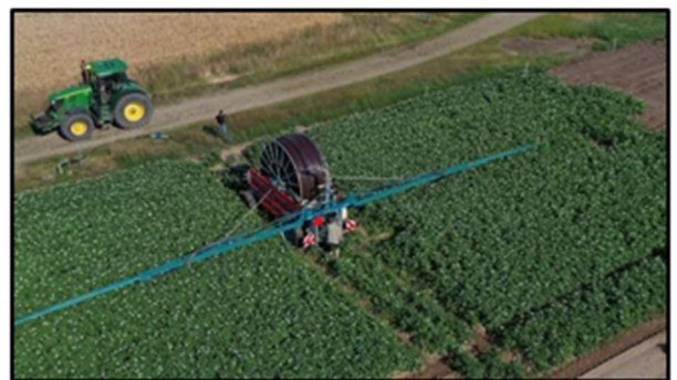
Fig V.2 : La rampe, le tuyau en PE et le bâti à tambour.
