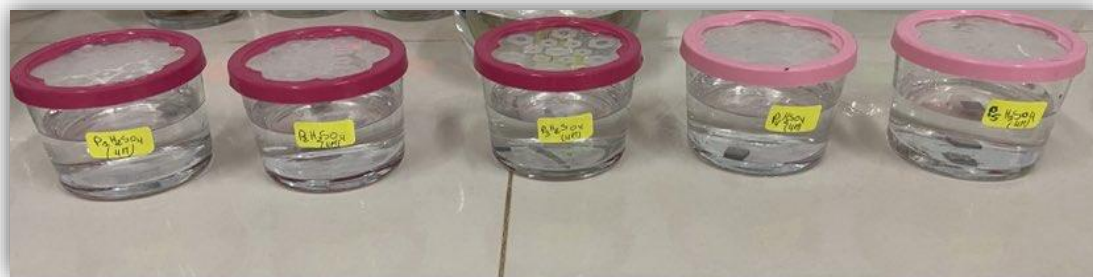
Figure III.6. Les échantillons immergés dans la solution corrosive.
