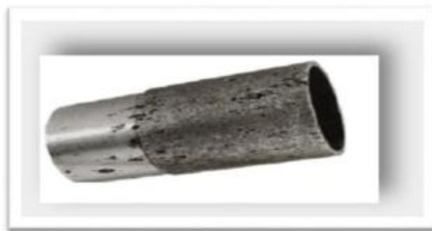
Figure I.4 : Corrosion par piqûres d'un acier inoxydable [7].
