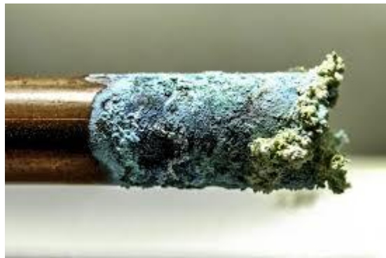
Figure I.12 : Produits de corrosion du cuivre.
