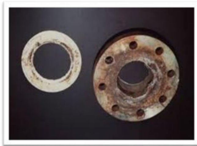
Figure I.5 : Corrosion caverneuse d'un acier allié sous un joint [9].
