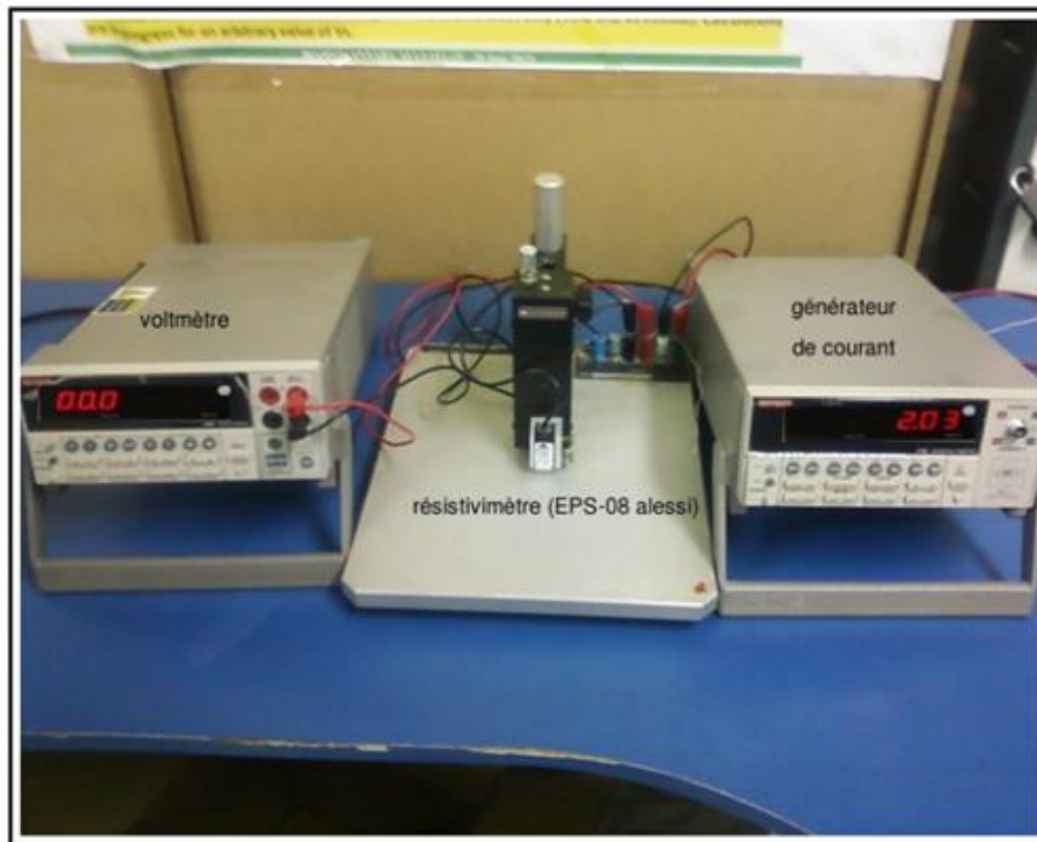
Figure II.6: Montage expérimental de la technique des quatre pointes .
