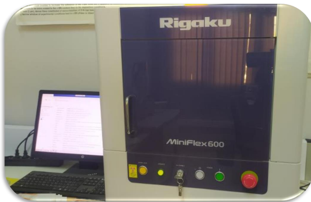
Figure II.10 : Diffractomètre à rayons X Rigaku-Type MiniFlex600 utilisé dans ce travail.
