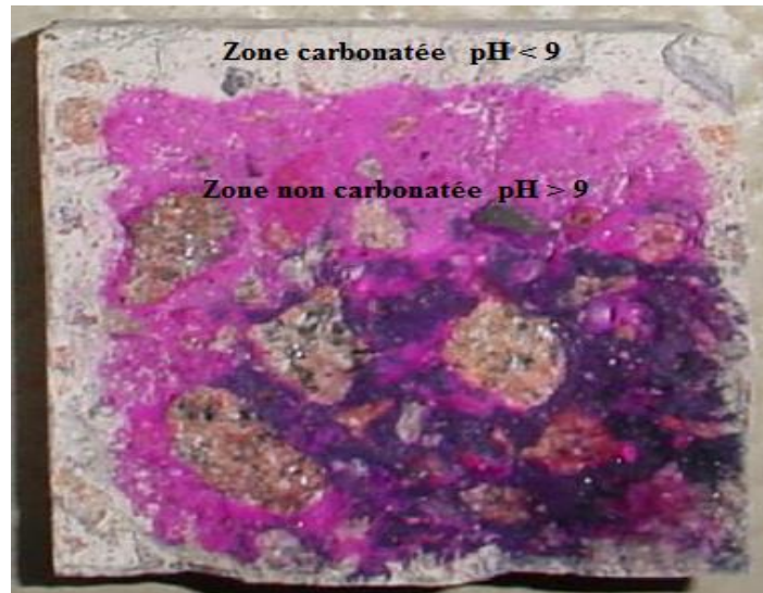
FigII.9 : Vue d'une fracture fraîche de béton après aspersion d'une solution de phénolphthaléine[14].
