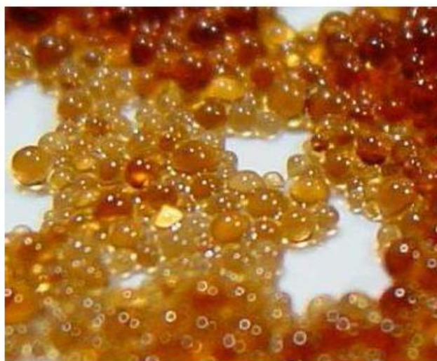
Figure I.8 Exemple de structure polystyrène sulfonée d'une résine échangeuse d'acide (à gauche) et une image représentative des billes de résine (à droite)
