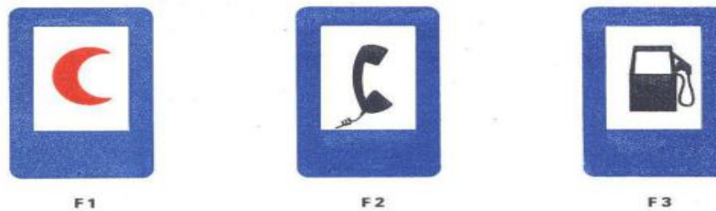
Fig V.1.11 : Autres Signaux Indiquant Des Installations Qui Peuvent Etre Utiles Aux Usagers De La Route (type F)
