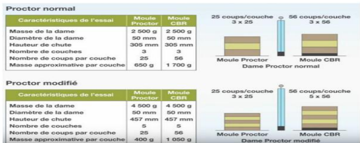
Figure V.1. 8 : Principe de l'essai Proctor normal et modifié
