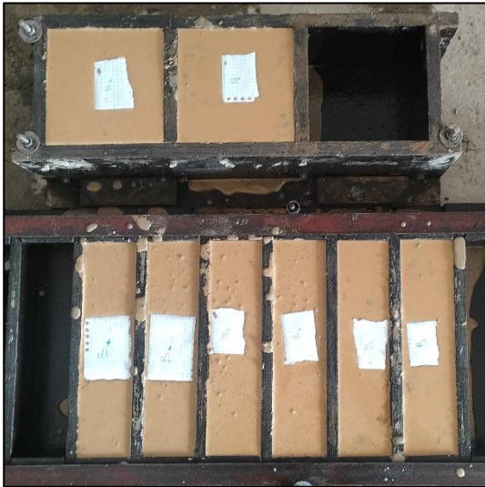
Fig.IV2 (a, b) Eprouvette avant et après le démoulage.
