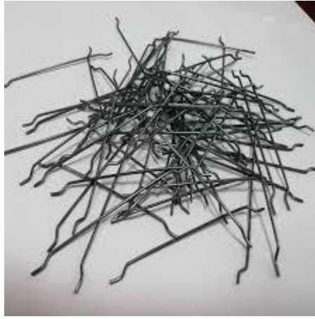
Fig.II.2 Fibre métallique (DRAMIX).
