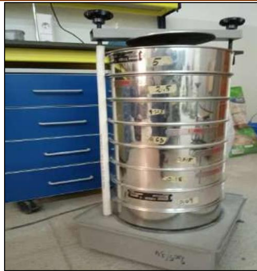
Fig.III.13 Essai analyse granulométrique.
