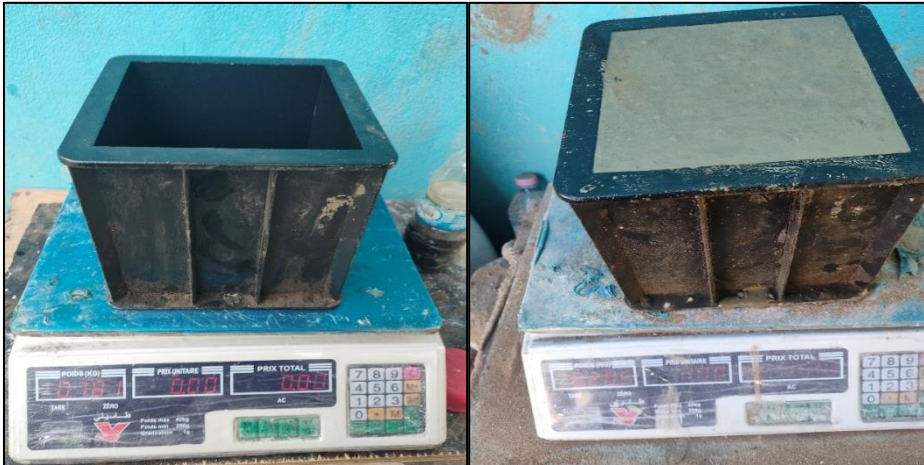
Fig.IV.5 Essai de la densité à l'état frais.
