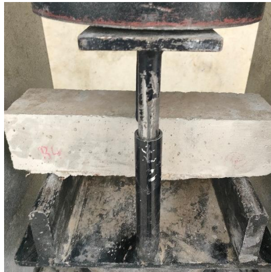
Fig.IV.8 Essai traction par flexion.
