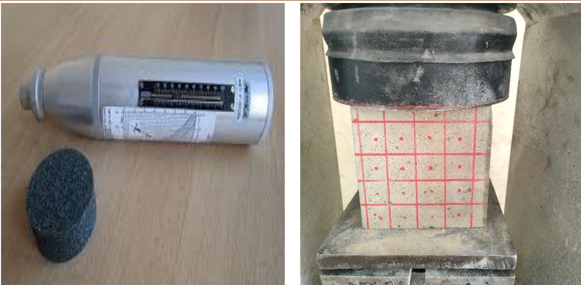
Fig.IV.8 Essai au scléromètre.
