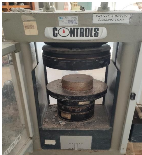
Fig.IV.7 Essai de compression
