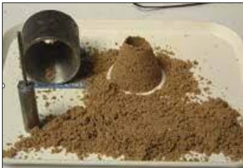
Fig.III.11 Coefficient d'absorption de sable.
