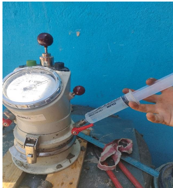
Fig.IV.6 Mesure de l'air occlus.
