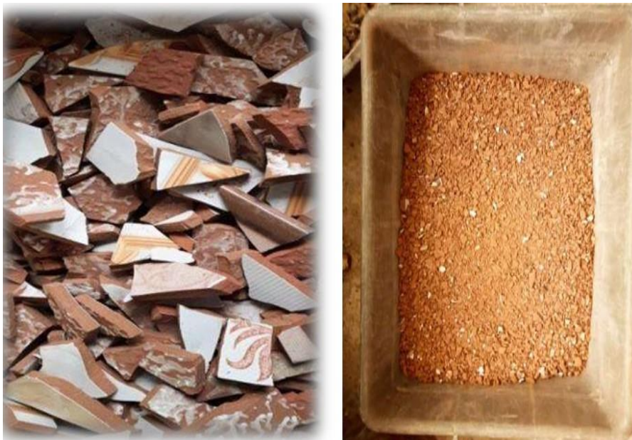
Fig.III.2 recyclage mécanique de la faïence.
