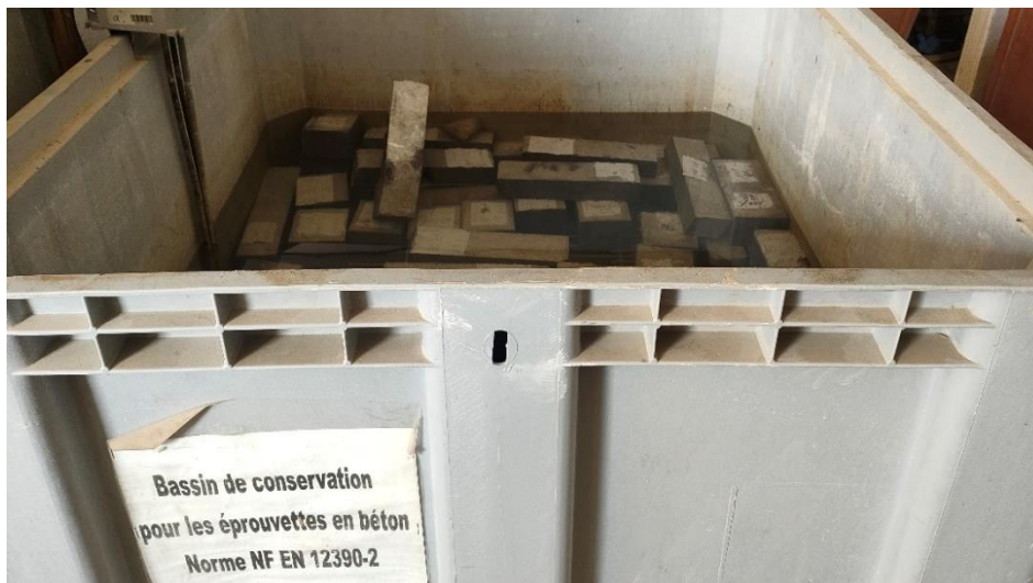
Figure IV.3 : Conservation des éprouvettes dans un bain d'eau.
