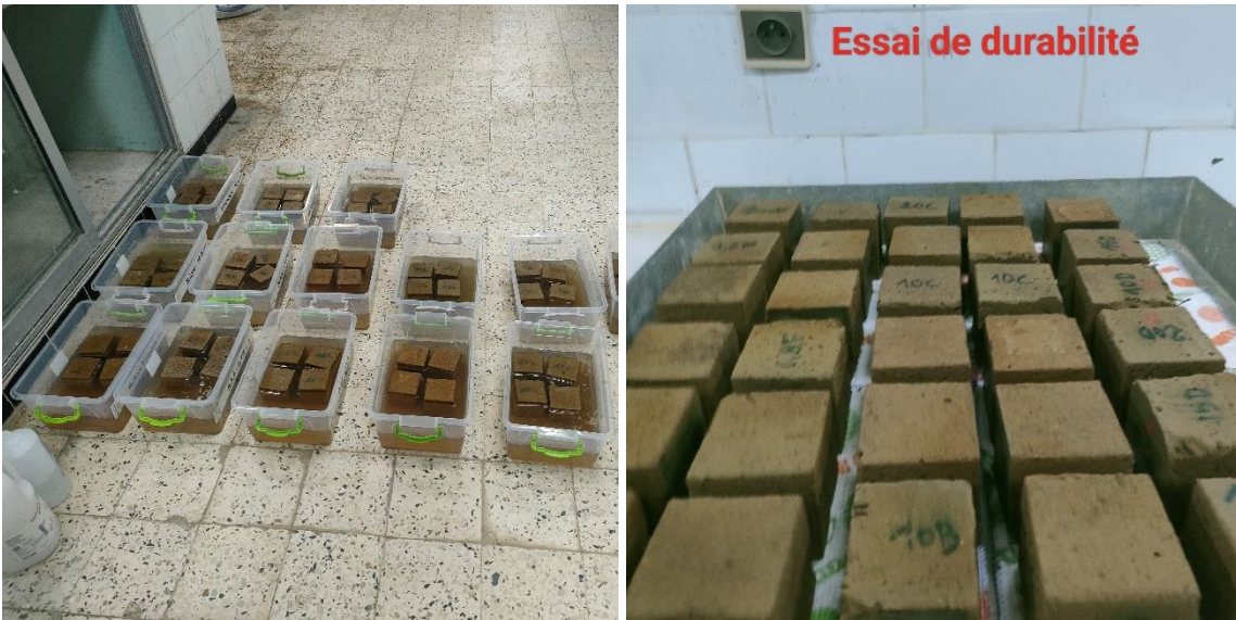
Fig.IV.12 Essai attaque des solutions chimiques.
