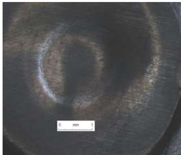
Figure IV.28: Surface de l'enclume – Contact inférieur
