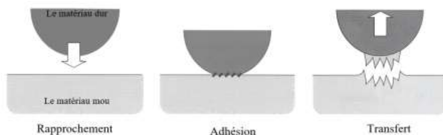
Figure I.2 : Processus de transfert de matière par adhésion (D'après [STAC 01])
