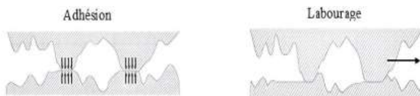
Figure I.1: Origines principales du frottement
