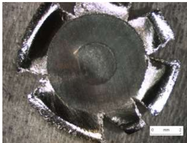
Figure IV.3: Échantillon déformé en mode classique : (a) Échantillon avant et après déformation, (b) Surface inférieure, (c) Surface supérieure
