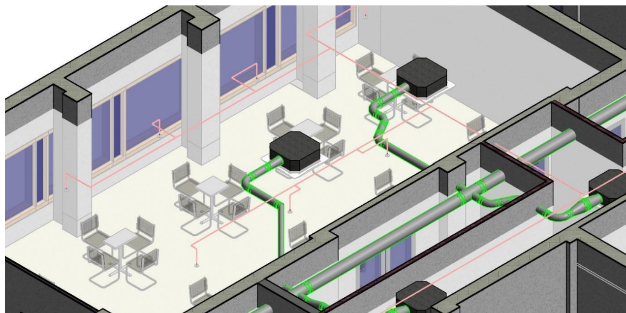
Figure 7.3 : schéma d'installation du Réseau HVAC 5ème étage -3-
