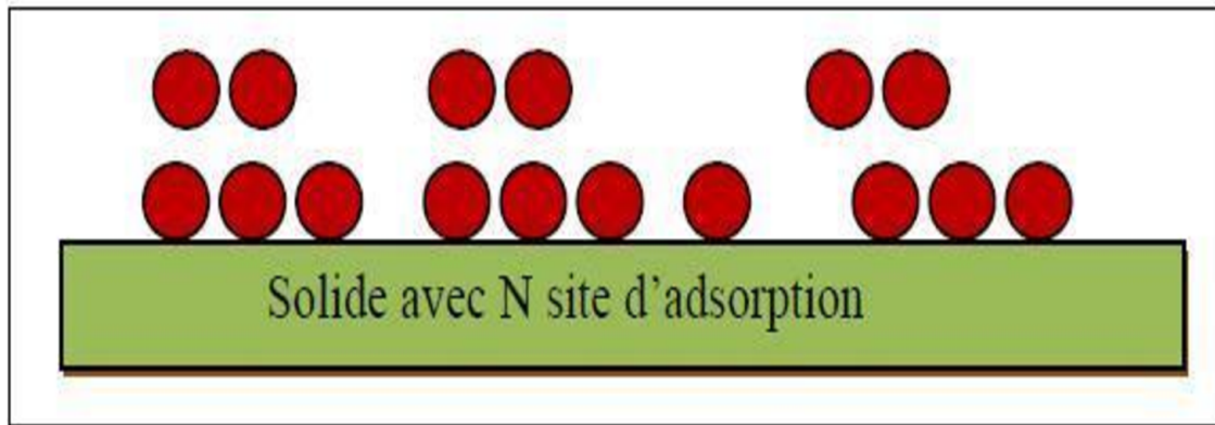
Figure II.5: Modèle d'adsorption de Freundlich en multicouches.
